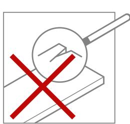
Перед началом укладки необходимо тщательно проверить плашки (панели) на наличие дефектов или повреждений. Делать это нужно при дневном свете. Укладка поврежденных панелей **НЕ** допускается (рис. 3)
