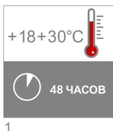
Пробковые полы укладываются при температуре от +18 до +30 °C. Перед укладкой материал необходимо оставить в помещении для акклиматизации не менее, чем на 48 часов. Температура в этом помещении должна быть также от +18 до +30°C, относительная влажность - 55-65% (рис. 1)
