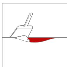
Важным условием надежной эксплуатации пробковых полов является качество подготовки основания. Для клеевых полов основание должно быть идеально ровным. Перепады не допускаются. (рис. 2)
